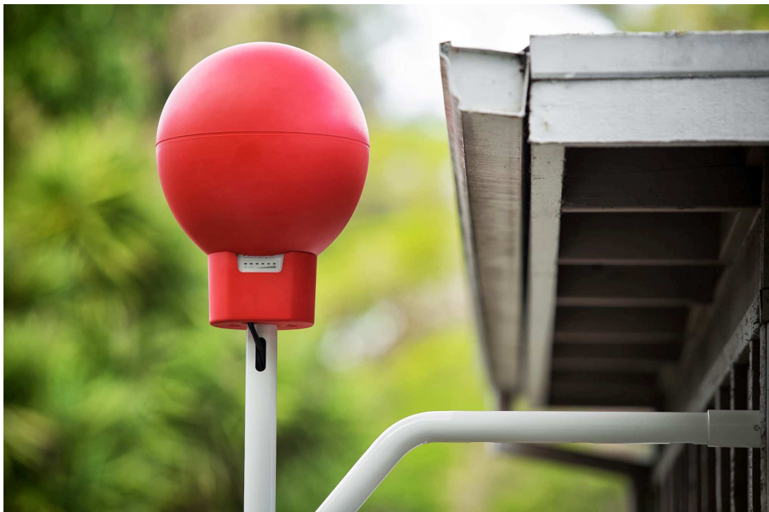
شکل ۲- آنتن‌های مخصوص دریافت داده از بالون‌ها
