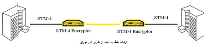
شکل ۸ : نمونه کاربرد دستگاه رمزکننده خطوط STM-4 در یک لینک Point-to-point
